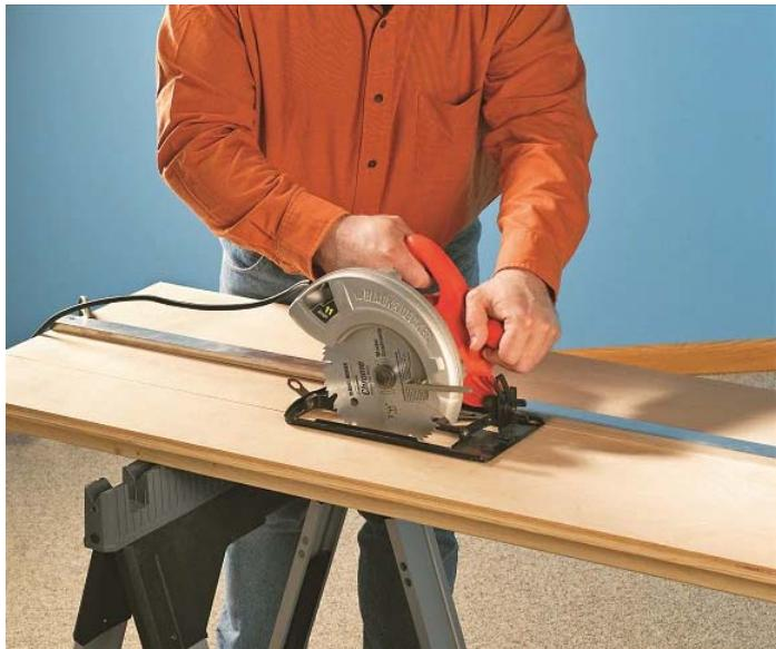
Coupez le matériel à l'aide d'une scie circulaire et d'un guide, et l'empiler soigneusement. Étiquetez chaque pièce (un marqueur sur du ruban-cache bleu fonctionne bien) pour faciliter l'identification ultérieure.
