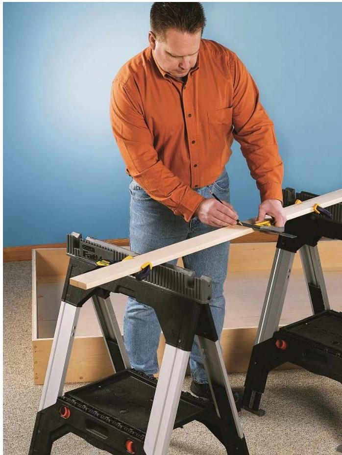
Disposez les emplacements pour les poteaux de balustrade sur le rail d'accouplement et les bouchons de boîte afin que vous soyez sûr qu'ils sont parfaitement alignés.
