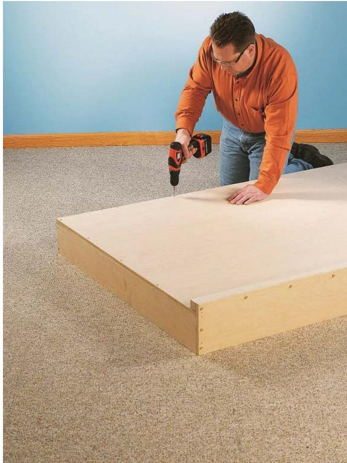
Attachez le fond de la boîte de matelas en contreplaqué en enfonçant des vis à travers le contreplaqué et dans les deux tasseaux montés à l'intérieur de la boîte. Enfoncez également des vis à travers le fond de la boîte et dans les bords arrière et droit de la boîte.
