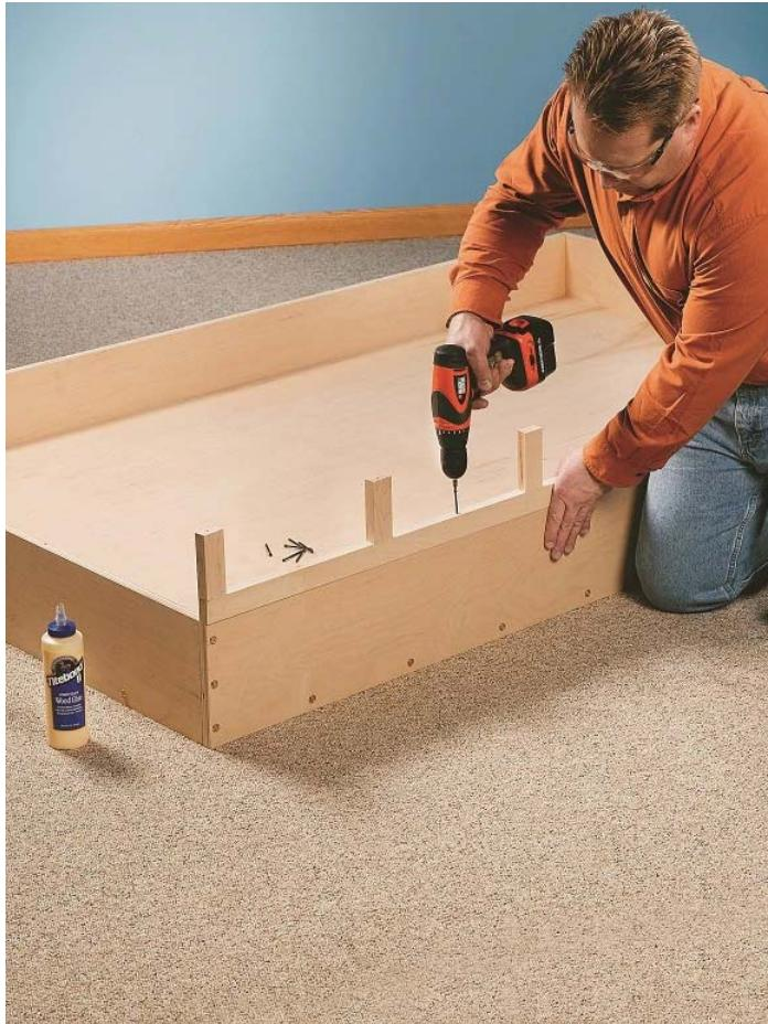
Après avoir vissé les poteaux de garde-corps aux boîtiers, fixez les assemblages aux côtés avant et gauche du caisson du matelas à l'aide de vis à tête compensée.
