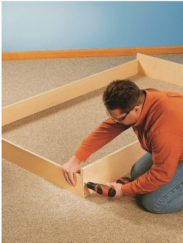
Liez les coins de la boîte de matelas avec de la colle et quelques clous ou avec de la colle et des étaux, et renforcez ensuite chaque joint avec 3 vis à bois en laiton no 8 de 63,50 mm (2½ po). Espacez les vis uniformément. Nous avons ajouté des rondelles décoratives en laiton à œillet au lieu de fraiser des trous à fond plat et de boucher les trous de vis.
